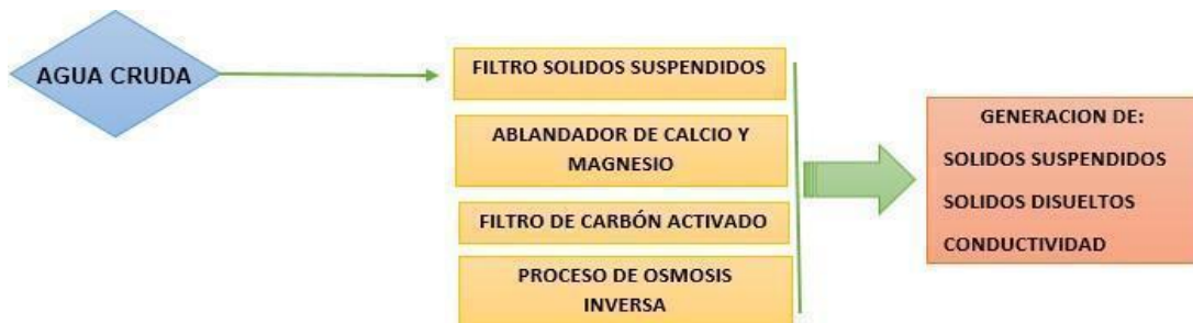
Figura 4. 7: Fase de captación de agua
