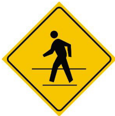
Imagen N°27 Señalética Tránsito peatonal
