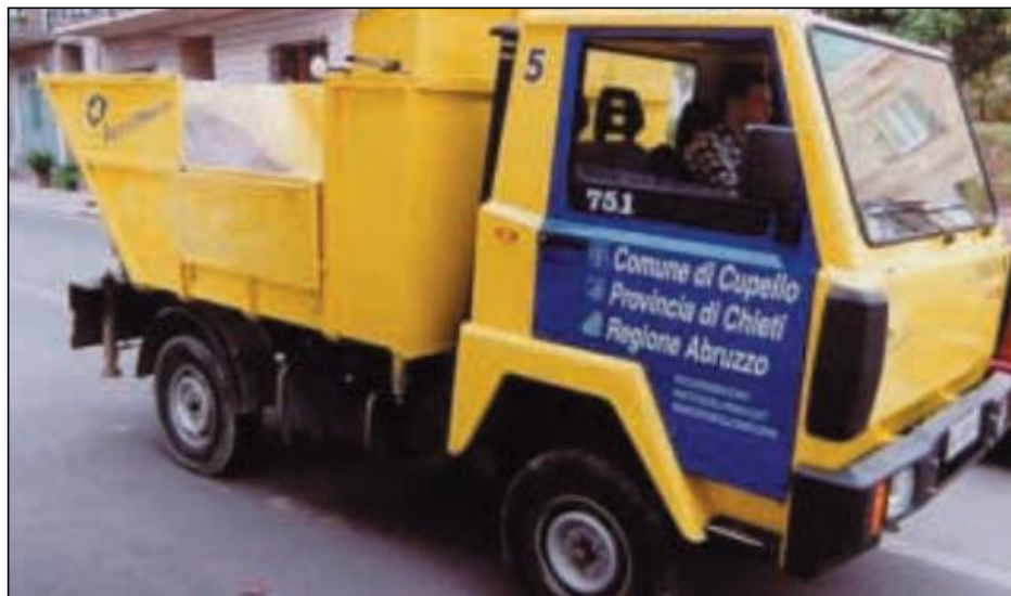
Figura 4.13 Camión tolva recolector de residuos orgánicos domiciliarios puerta a puerta
