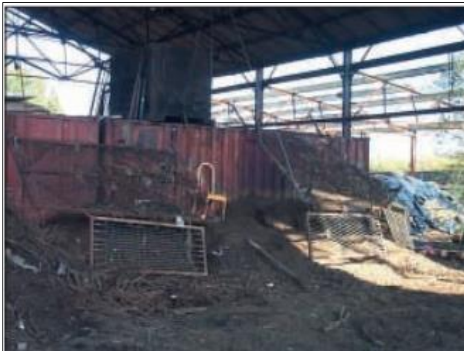
Figura 4.15 Cribado artesanal con antiguos somieres en centro de compostaje
