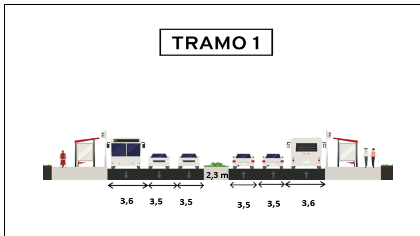
Figura N° 5.3: Perfil de calzada del tramo 1
