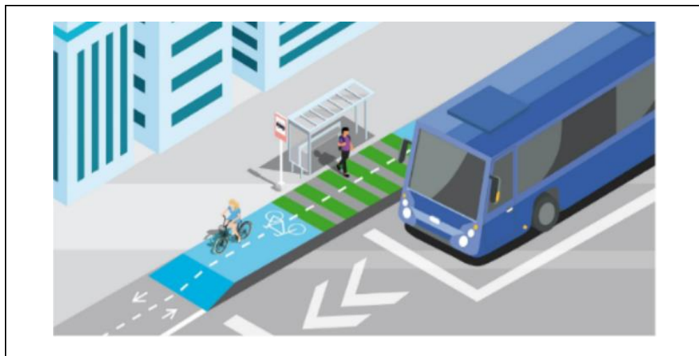
Figura N° 6.18: Diseño de Plataforma Elevada
