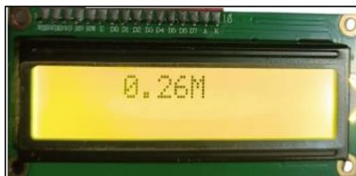
Ilustración 34: Valores obtenidos por el sensor de nivel mostrados en el LCD.
