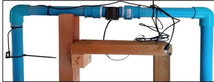
Ilustración 31: Disposición del sensor de caudal en la maqueta.
