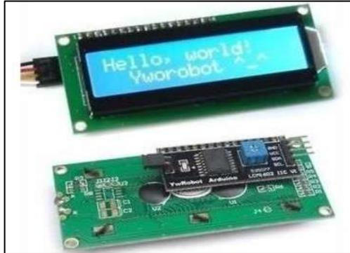
Ilustración 12: Pantalla LCD 16x02.
