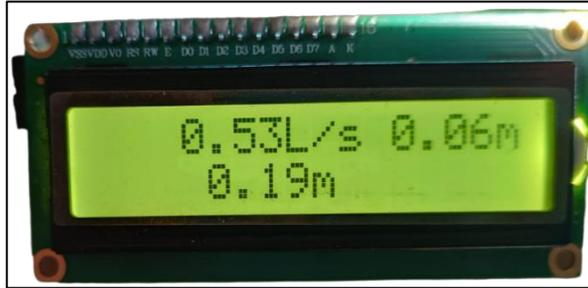
Ilustración 49: Valores enviados por el transmisor mostrados en el LCD.
