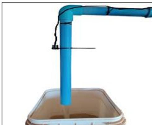
Ilustración 36: Disposición del sensor de nivel en la maqueta.
