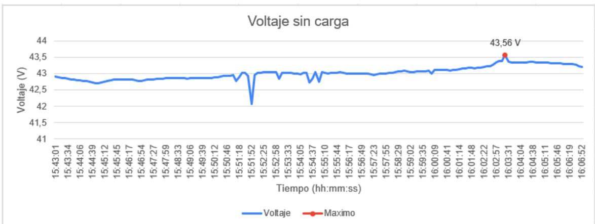
Ilustración 32: Gráfico de línea del voltaje de salida del panel luego de ser limpiado.
