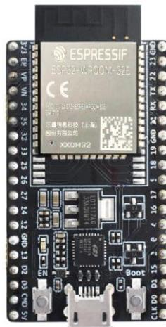
*Ilustración 18: Microcontrolador ESP32. Fuente:*
