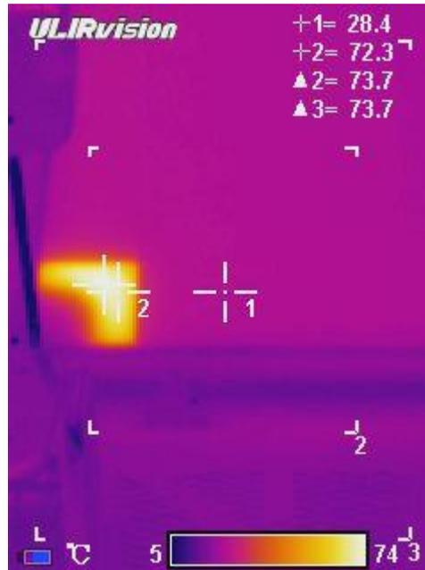
*Ilustración 48: Imagen térmica del hotspot provocado de manera intencional en tres cuarto de la celda exponiendo el panel a una sombra, llegando a los 73,7°C.*
