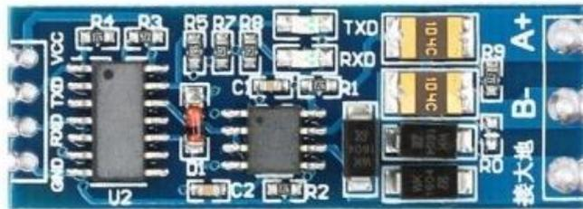
Ilustración 17: Interfaz RS485. Fuente: <https://maxelectronica.cl/componentes-electronicos/591-modulo-conversor-serial-ttl-a-max485-rs485-3p.html>
