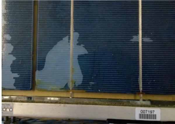
*Ilustración 13: Panel fotovoltaico que presenta la degradación tipo delaminación. Fuente: <https://amaranzero.mx/academia/blog/enemigos-de-la-fotovoltaica-delaminacion>*
