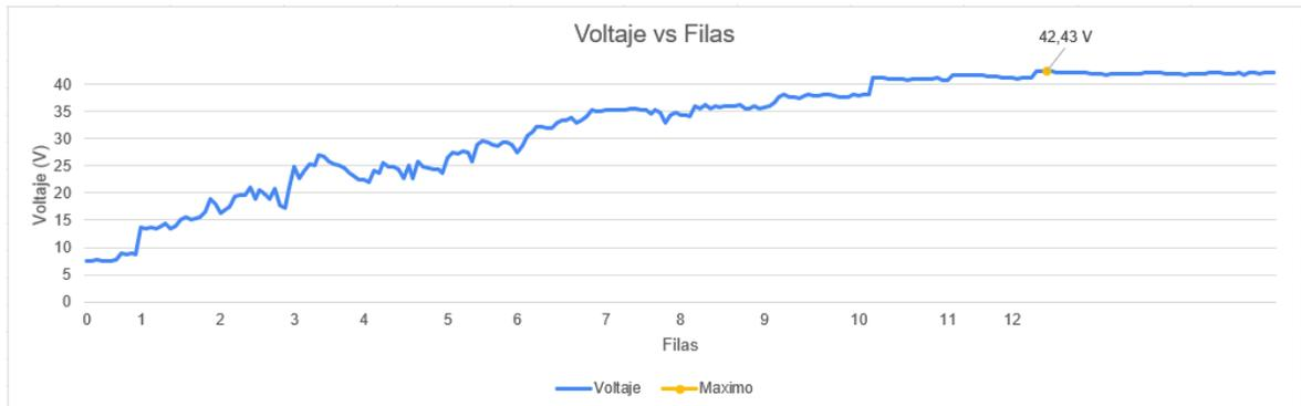
*Ilustración 33: Gráfico obtenidos a partir de los 241 datos medidos durante 22 minutos aproximado. Se observa el aumento del voltaje de salida según se iban descubriendo secuencialmente las filas de celdas al ir retirando la placa metálica que bloqueaba la radiación solar.*
