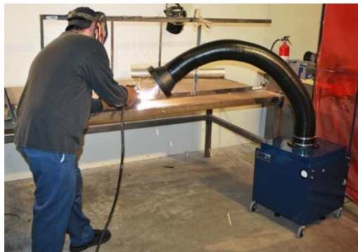
Figura 21: Extractor móvil auto filtrante para humos de soldadura
