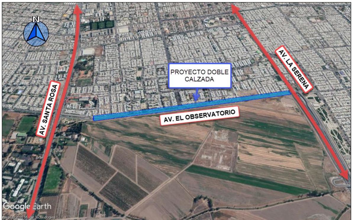
Figura N° 1.2: Tramo Análisis de Doble Calzada.
