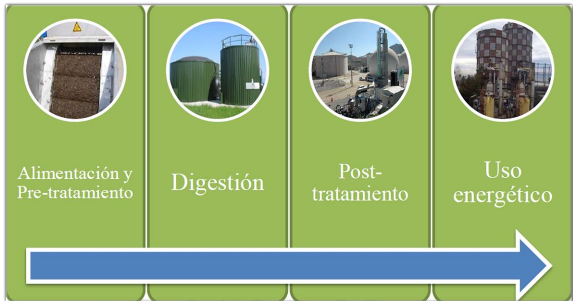
Ilustración 4-9 etapas para generación de biogás
