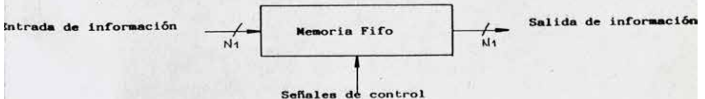
FIGURA N o 2 DIAGRAMA DE BLOQUES DE UNA MEMORIA FIFO
